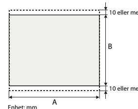
Ett utrymme på minst 10 mm vid GOT-enhetens övre och nedre sida krävs, för att ge utrymme att ansluta monteringselementen.
