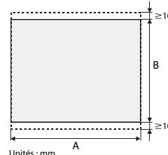
Un espace minimal de 10 mm au-dessus et au-dessous du terminal GOT est indispensable pour les fixations.
