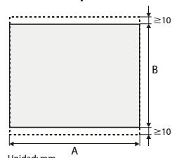
Debe dejarse un espacio de como mínimo 10 mm en los lados superior e inferior del GOT con el fin de permitir la sujeción de los adaptadores de montaje.
