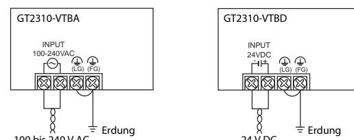
Verwenden Sie zur Reduzierung des Spannungsabfalls Leitungen mit dem größtmöglichen Querschnitt (max. 2 mm²) und verdrillen Sie die einzelnen Äder bis kurz vor den Anschlussklemmen. Ziehen Sie die Schrauben der Klemmen mit einem Moment von 0,5 bis 0,8 Nm an.
