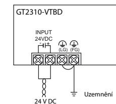
K omezení úbytku napětí použijte vodiče s průřezem minimálně 2 mm<sup>2</sup>. Šrouby by svorek utahujte momentem od 0,5 do 0,8 Nm. K připojení napájecího napětí použijte běžně dostupná kabelová oka nebo nástrčky pro šrouby M 3 (viz dole).
