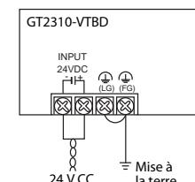
Utilisez des fils de section maximale 2 mm<sup>2</sup> pour éviter les chutes de tension ; serrez les vis des bornes à un couple compris entre 0,5 et 0,8 Nm. Veuillez utiliser pour le raccordement de la tension d'alimentation descosses à oeillet ou à fourche pour vis M3 (voir ci-dessous).
