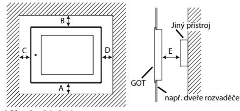
Hodnoty v závorkách platí pro případ, že v blízkosti panelu nejsou žádné přístroje, jako jsou např. jističe, které vydávají elektromagnetické rušení nebo vyzárují teplo.
