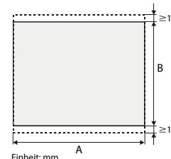
An der Ober- und Unterseite des GOT ist ein freier Raum von mindestens 10 mm für die Befestigungselemente erforderlich.
