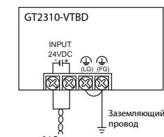
Во избежание падения напряжения используйте для подключения питания толстые провода сечением до 2 мм<sup>2</sup>. Надёжно затяните винтовые клеммы моментом 0,5–0,8 Нм.
