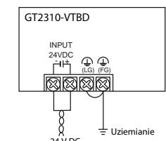
Celem uniknięcia spadek napięcia należy używać kabli o przekroju 2 mm<sup>2</sup> lub większym. Porządkie dokręcić śruby z momentem 0,5 do 0,8 Nm. Do podłączenia napięcia zasilającego należy stosować dostępne w handlu zakończenia przewodów przeznaczone do śrub M3 (zob. poniższy rysunek).
